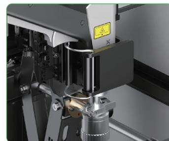
(5) Fixe os três anéis de fixação no cabo da cabeça de soldadura às ranhuras correspondentes no interior da máquina.
