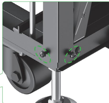
(3) Fixe as restantes três barras de fixação compridas da mesma forma. Depois, utilize a chave Allen para apertar todos os parafusos completamente nas quatro barras de fixação compridas.
