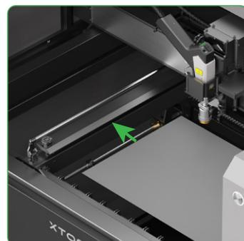
(7) Insira o lado esquerdo do material na calha esquerda.
