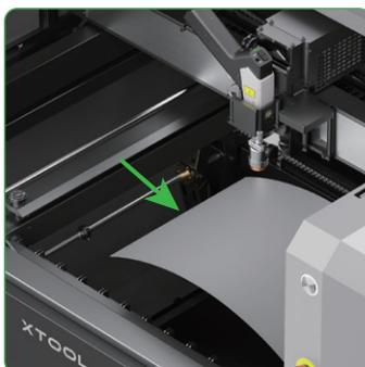
(6) Desloque a calha esquerda para a direita.
